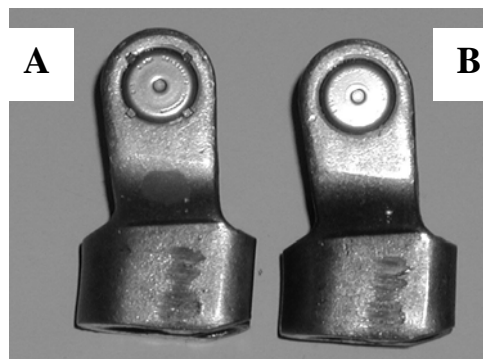
Figura 2 – Juntas com (A) e sem cravamento (B).
