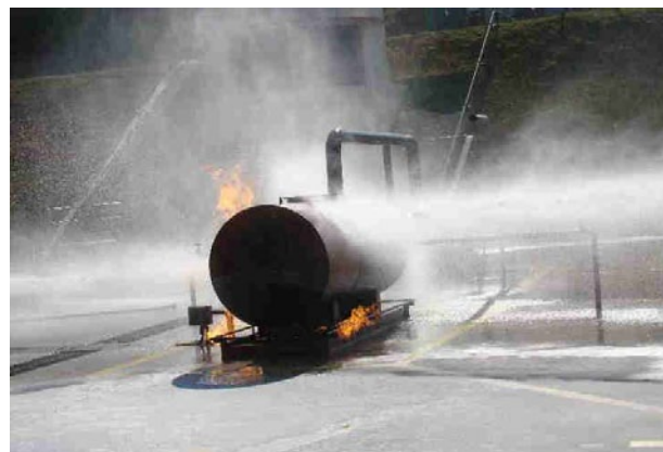
Figura 14 – Aspecto de aplicação de água no reator
