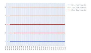
En la siguiente imagen se muestra un ejemplo de una planificación de 7 aeronaves. En este modelo no se distingue entre zonas del incendio. Como en la imagen anterior, las aeronaves están representadas en el eje vertical. Las líneas de puntos representan los desplazamientos de las aeronaves, y las líneas sólidas su tiempo de trabajo en el incendio.
