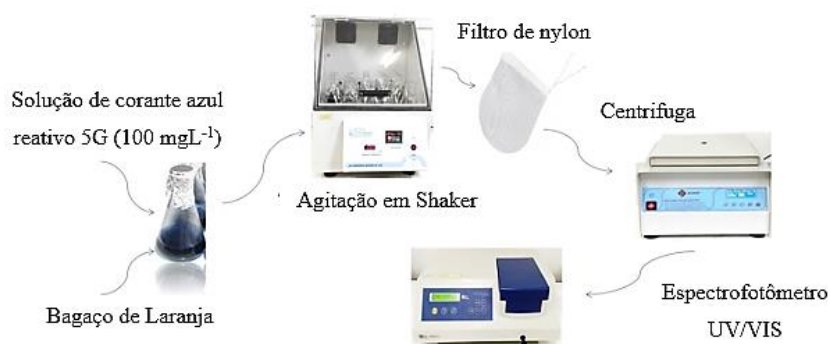
Figura 2: Procedimento e equipamentos utilizados nos ensaios de adsorção
