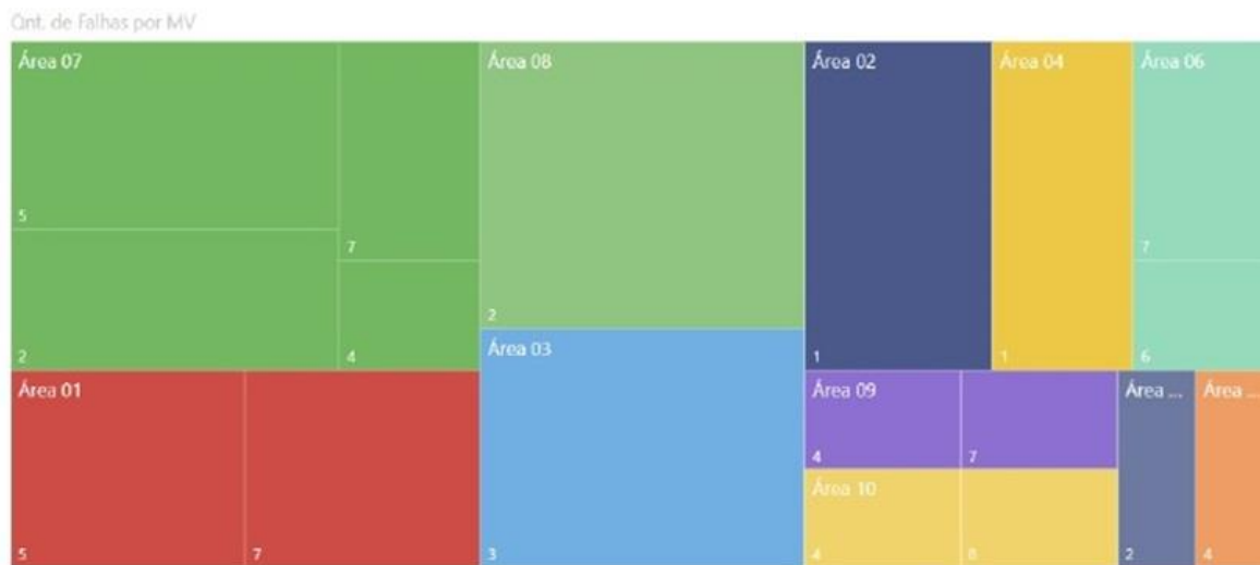
Figura 4. Número de falhas por Área e MV Station para os módulos de fase dos inversores.
