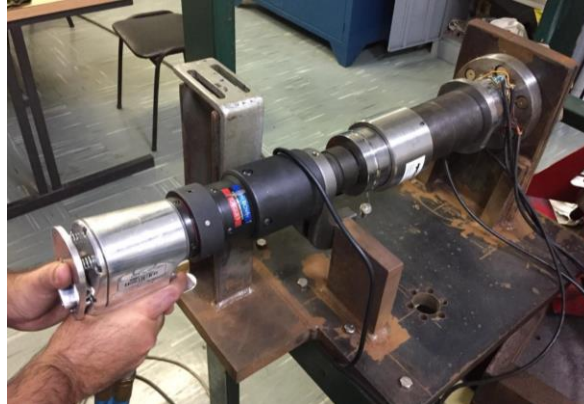
Figura 7. Exemplo do aparato experimental para ensaio de torque dos fixadores de 1.1/2".
