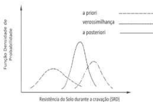
Figura 1 - Relação entre a distribuição “a priori”, verossimilhança e “a posteriori” da resistência do solo durante a cravação, Goulois e Lacasse (1989); Lacasse et al. (1991).
