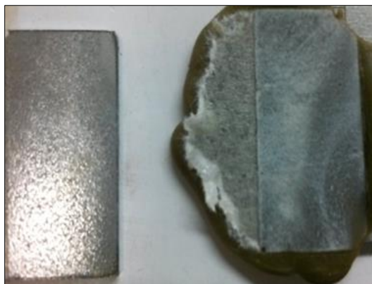
Figura 4: Ruptura adesiva na junta sem preparação superficial.
