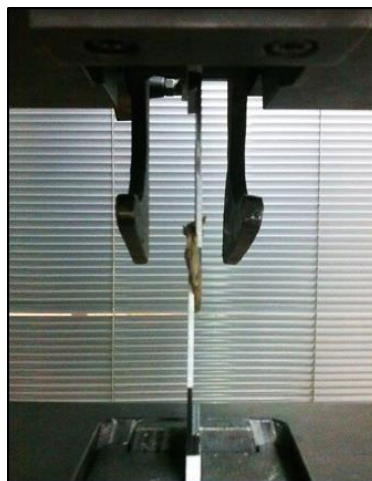
Figura 3: Corpo de prova fixado na máquina para realização do ensaio de cisalhamento.
