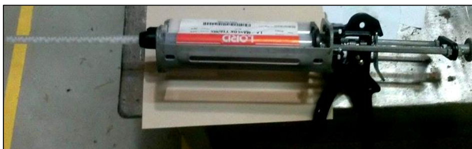
Figura 1: Pistola para aplicação manual do adesivo.
