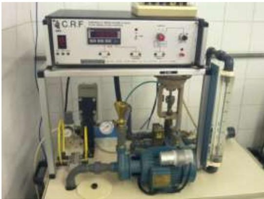
**Figura 2.** Planta de monitoração e controle de fluxo (CRF) da *DidactaItalia* que se encontra no LACOPI/IFPA.
