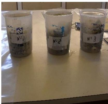
**Figura 1:** Bécheres para a determinação da massa específica, absorção e porosidade.
