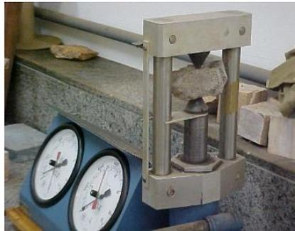
**Figura 3:** Sistema de aplicação de carga pontual.
