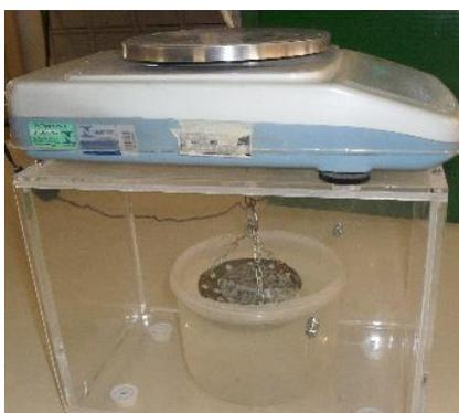
**Figura 2:** Balança e dispositivo de pesagem hidrostática para a determinação da massa específica, absorção e porosidade.
