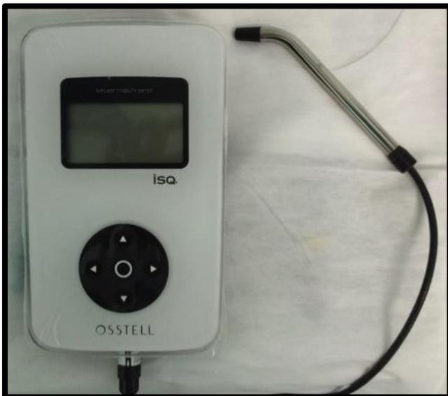
**Fig. 3** – Aparelho Osstell® que mede a estabilidade do implante no osso (unidade ISQ).
