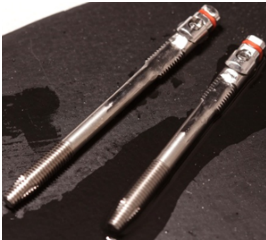
FIGURA 5. Aspecto final dos implantes após a usinagem.
