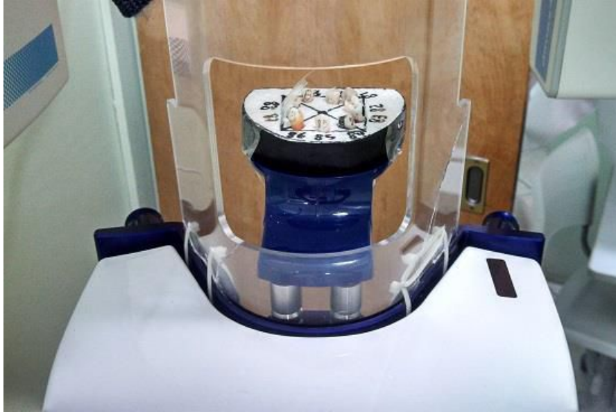
Figura 3. Dentes acomodados na base de isopor para a tomada tomográfica.
