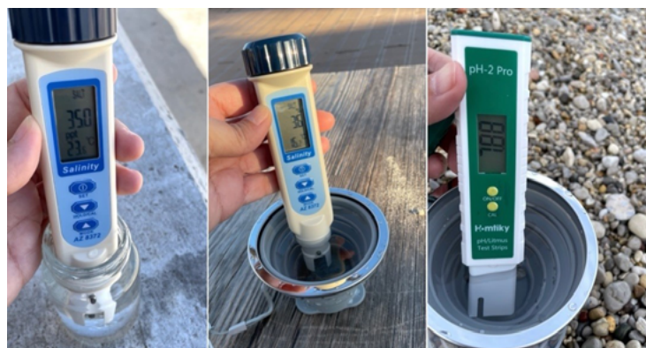
Fig. 5 - Medidores de salinidade e pH. Fotos da autora
