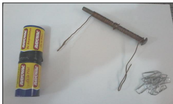
Figura 01: Experimento: construindo um eletroímã
