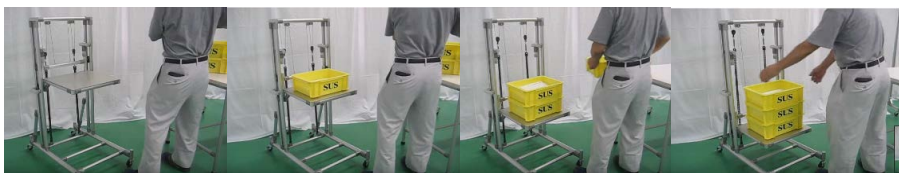
Figura 3. Karakuri Elevador de Nível (Thaicubic Chockwatta, 2012).
