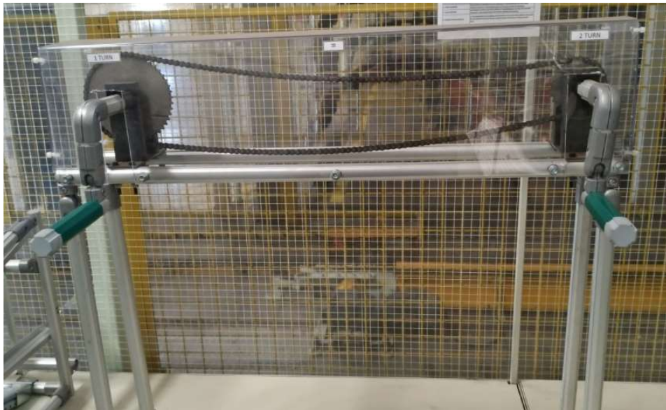
Figura 30: Karakuri de transferência de rotação
