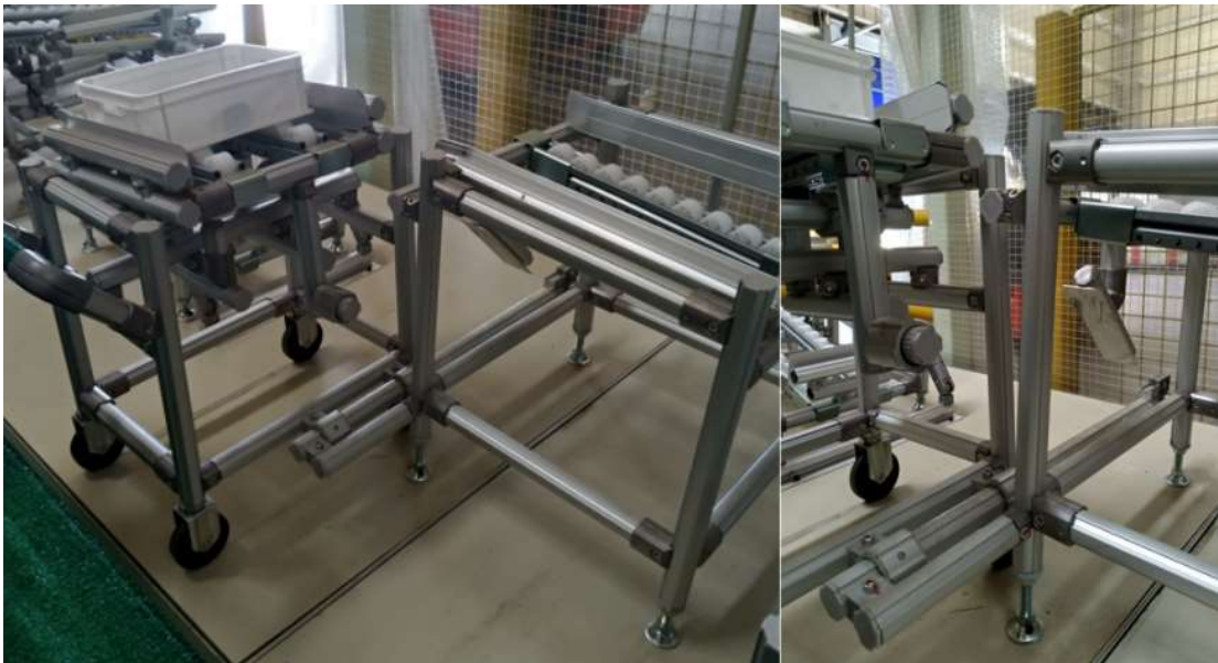
Figura 32: Karakuri de alimentação de linha
