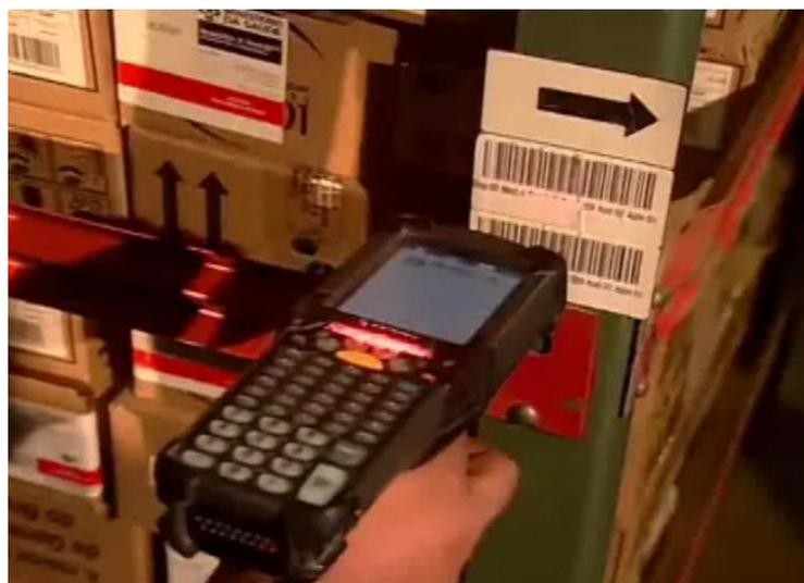
**Figura 9** – Separação através de coletores de dados por rádio frequência
