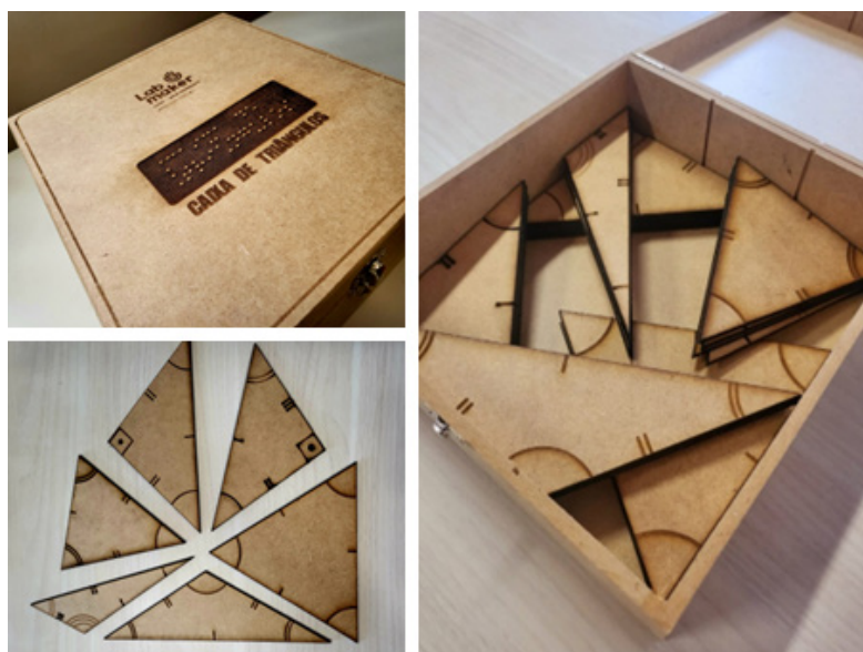
Figura 1. Recurso didático intitulado Caixa de Triângulos, produzido via corte e gravação a laser
