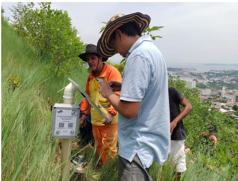
Figura 8. Instalação de sensor de focos de incêndio e deslizamento no Morro do Boa Vista.
